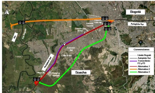
**Ilustración 1:** Alternativas de trazado Optimización Bogotá - Soacha
