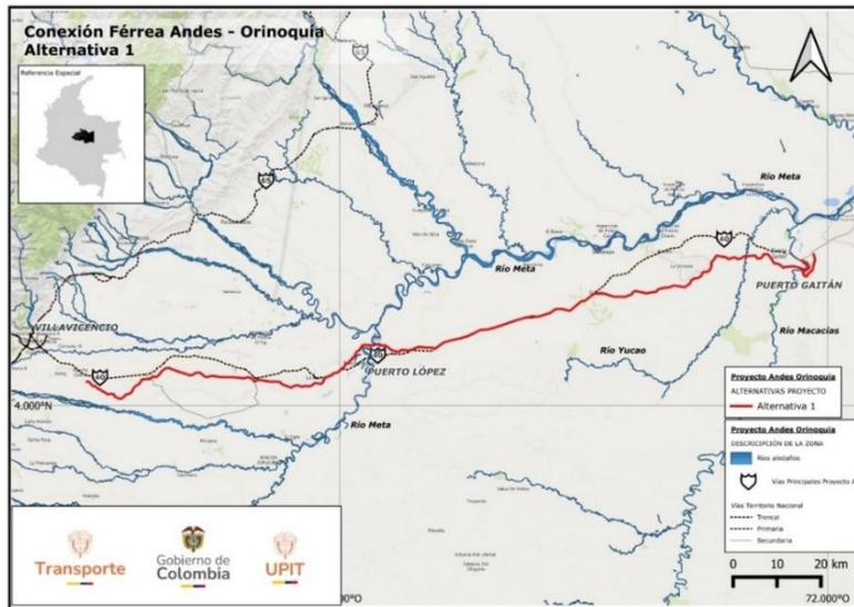
**Ilustración 4.** Alternativa de trazado No. 1 conexión férrea Andes - Orinoquía
