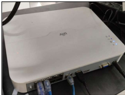
Ilustración 17 - NVR UNV ref NVR301-08LB-P8 GIT de Tecnología de la Información y las Comunicaciones
