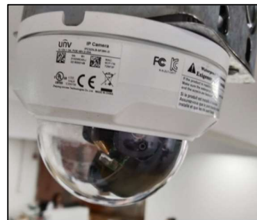
Ilustración 18- cámaras IP UNV ref IPC323LB-SF20K-G GIT de Tecnología de la Información y las Comunicaciones
