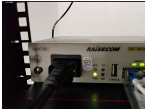
Ilustración 14 - Demarcador Raisecom RAX700 GIT de Tecnología de la Información y las Comunicaciones
